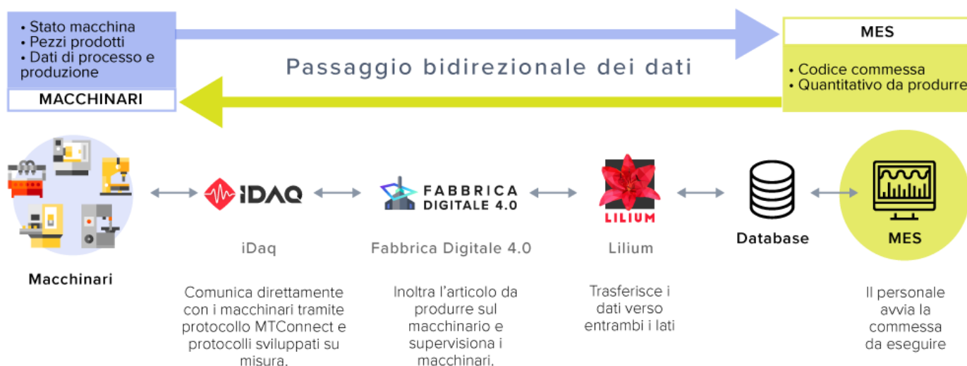
Diagramma dell'interconnessione aziendale della soluzione software Industria 4.0
